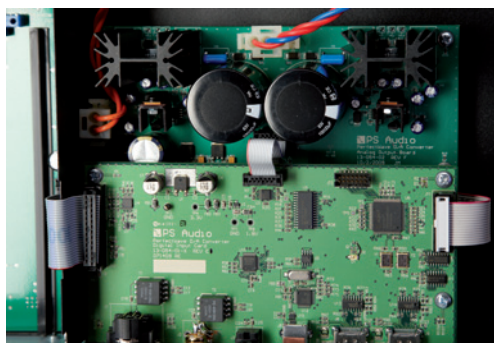
LEIDER VERDECKT DIE DARÜBER ANGEORDNETE DIGITALPLATINE DEN BLICK AUF DIE FEINEN BAUTEILE DER ANALOGEN AUSGANGSSTUFE
