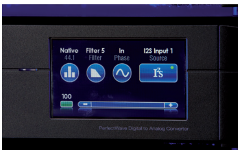
ÜBER DEN TOUCHSCREEN DES PWT LASSEN SICH DIE GEWÜNSCHTE FREQUENZ FÜR DAS UPSAMPLING, DIE DIGITALFILTER, DIE PHASENLAGE UND DER EINGANG WÄHLEN. AUCH DIE LAUTSTÄRKE DES AUSGANGSSIGNALS WIRD HIER GEREGELT
