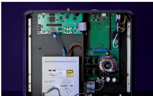
NACH DEM ENTFERNEN DES HOCHGLANZ LACKIERTEN MDF-DECKELS WIRD DER BLICK AUF DAS GEKAPSELTE DVD-LAUFWERK, DIE KRÄFTIGE STROMVERSORGUNG UND DIE PLATINE MIT DER DIGITALEN SIGNALAUFBEREITUNG (DIGITAL LENS) FREI
