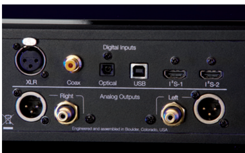
DAS ANSCHLUSSFELD DES PWT: FÜR DIE VERBINDUNG ZUM LAUFWERK WURDE AUSSCHLIESSLICH DIE HDMI-SCHNITTSTELLE BENUTZT. DAS ANALOGSIGNAL GELANGTE AUF SYMMETRISCHEM WEG ZUR BRINKMANN-VORSTUFE
